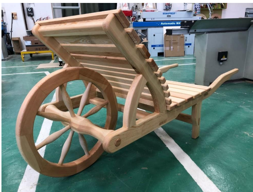
Práce žáků 3. ročníku oboru truhlář a mistra (učitele odborného výcviku) - výroba a vzorování prototypu – kombinace ruční výroby, CNC Holzher a soustruhu – cca 2 měsíce. Impozantní kus koncipovaný jako luxusní lehátko, nebo pohovka k bazénu nebo na pergolu – rozměr šířka 65cm a délka 200cm pochází z učební truhlářské dílny pod vedením Ing. Václava Dudy.
